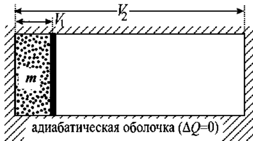
Рис. 9.4. Слева от перегородки в сосуде находится газ. После удаления перегородки газ расширяется в пустоту от объема V_1 до объема V_2 . Сосуд окружен адиабатической оболочкой.
