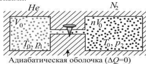
Рис. 6.16. Теплоизолированные сосуды объемом V_0 и nV_0 соединены друг другом тонкой трубкой с краном и заполнены различными газами.
