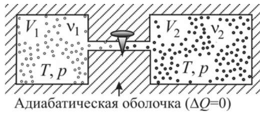
Рис.6.12. Теплоизолированные сосуды, имеющие объемы V_1 и V_2 , соединены друг с другом тонкой трубкой с краном и заполнены разными газами.
